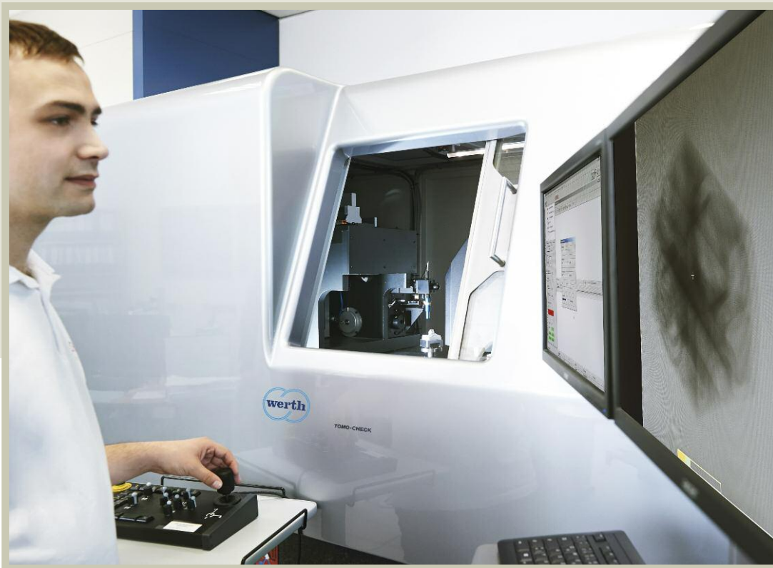
Bild 4. Dank neuer Steuerungs- und Sensortechnik werden im Hause Scholz nun Messgenauigkeiten von 1 µm erzielt. Auf Referenzmessungen mit taktilen Sensoren kann weitgehend verzichtet werden
