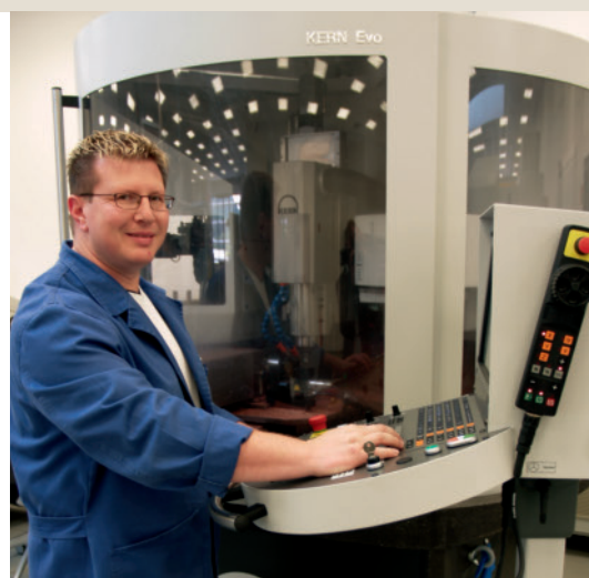
Bild 2. Matthias Hohner, Spezialist fürs Mikrofräsen bei Scholz: »Wichtiger als maximale Spindeldrehzahlen ist eine werkstoffgerechte Abstimmung von Drehzahl, Vorschub und Bearbeitungsstrategie.«
