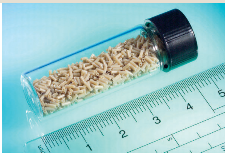
Bild 1. Erfordert höchste Präzision beim Mikrospritzgießen: Hülse aus PEEK für die Zahnmedizin mit einem Gewicht von 1 mg und einer Wanddicke von 150 µm
