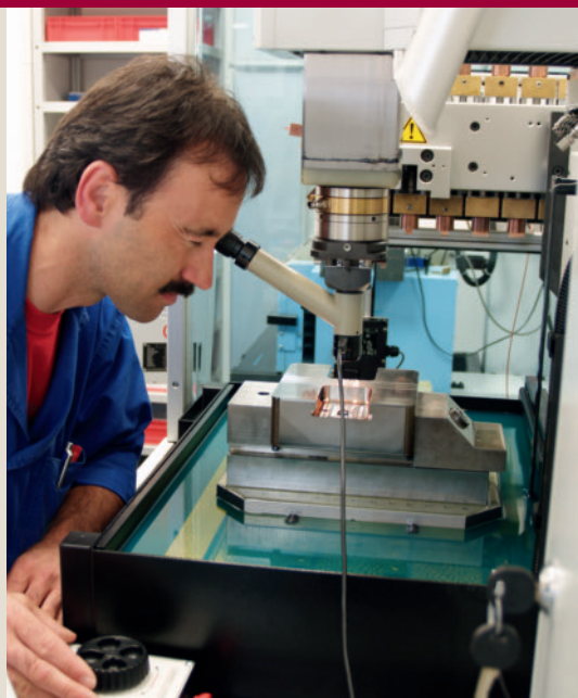
Bild 3. Prüfender Blick von Stefan Eckardt bei der Einrichtung der Senkerosionsmaschine: »Um Temperaturschwankungen zu vermeiden, erfassen wir die Temperaturen in der Umgebungsluft, im Dielektrikum und an der Maschine und klimatisieren auf \pm 0,3 K.«
