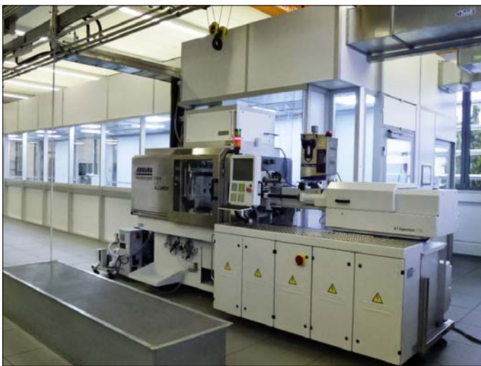
Das Spritzgiessen von Mikroimplantaten erfolgt bei Scholz-HTIK in GMP-Reinraumsystemen der Marke CleanSteriCell von Schilling Engineering.
