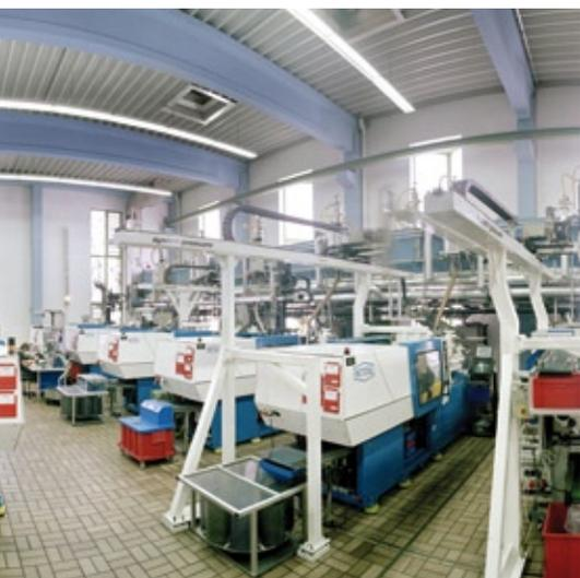
**31 Hochleistungs-Spritzgießmaschinen mit Schließkräften zwischen 35 und 175 Tonnen stehen in Kronach zur Verfügung. Hinzu kommen noch die Mikrosystem-Anlagen.**
