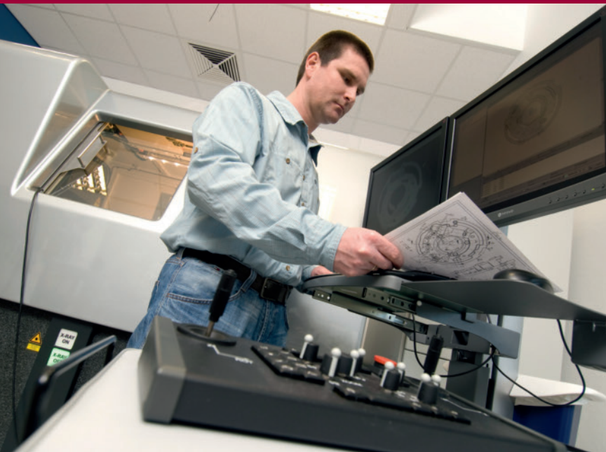
Bild 3. Alexander Zwosta, CT-Messtechnik-Spezialist bei Scholz: Die Genauigkeit der CT-Daten hängt unter anderem von der Messstrategie, der Aufspannung und der Bauteilbeschaffenheit ab und beträgt im Idealfall 2 µm
